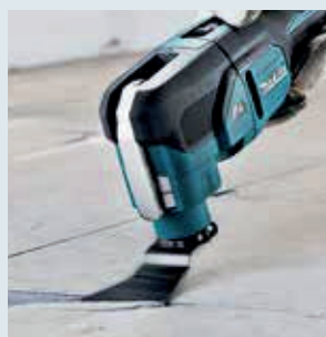
Retirada de baldosas
